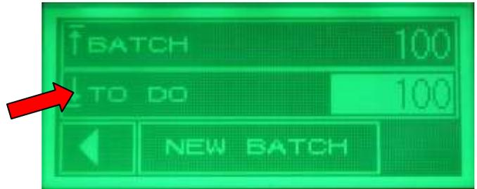
Premendo l'icona in basso al centro con la scritta NEW BATCH, appare una tastiera mediante la quale è possibile inserire un nuovo valore del lotto di produzione.
