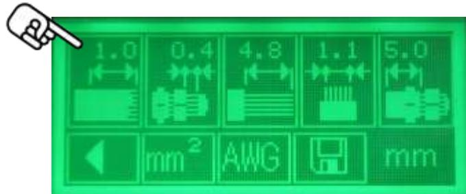
L'icona che si trova alla vostra sinistra nel menu, vi dà la possibilità, premendola, di attivare o disattivare la funzione. Disattivando la funzione, automaticamente si torna alla schermata iniziale.
