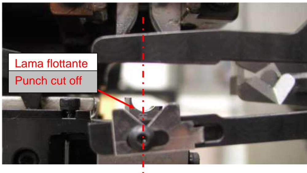
Qualora le pinze non fossero centrate con l'asse di aggraffatura del cavo, si può allentare la vite presente sulla pinzetta e spostare il lamierino di centraggio cavo, quanto basta per portarlo nella posizione corretta.
