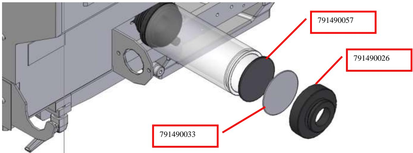
La sostituzione dei filtri avviene tirando il coperchio 791490026, rimuovere i filtri 791490033 e 791490057 e sostituirli con quelli nuovi. Richiudere il tappo.
