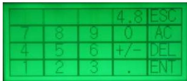
Se i valori inseriti attraverso la tastiera non sono validi, cioè non si attengono ai parametri impostati, nel momento in cui viene data la conferma comparirà un messaggio che vi avviserà dell'errore.
