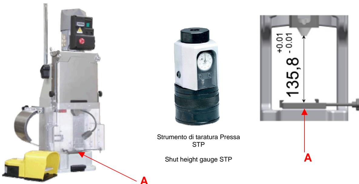
Strumento di taratura Pressa
