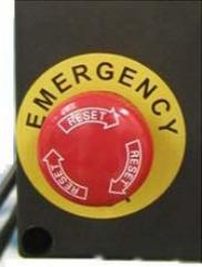
Se si verificasse la necessità di arrestare la macchina in qualsiasi momento del ciclo, premere il pulsante di emergenza.
