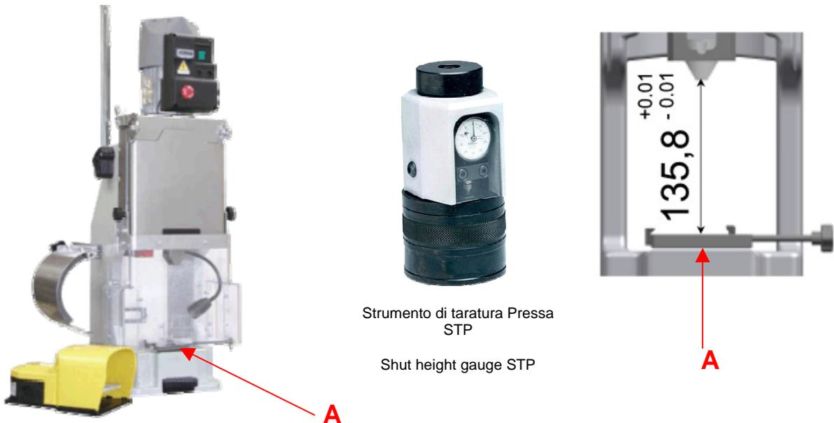
Questa operazione preliminare è molto importante per il corretto funzionamento. Pulire la superficie di staffaggio "A" garantendo il massimo piano di appoggio fra la base della pressa e quella dell'applicatore. Settare con apposito Strumento di Taratura STP l'altezza di lavoro corretta che deve essere (PMI) di 135,8 (+/-0.01)mm.
