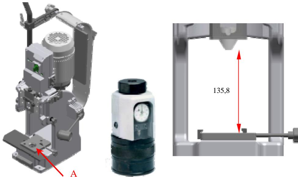
Questa operazione preliminare e' molto importante per il corretto funzionamento. Pulire la superficie di staffaggio **A** garantendo un buon appoggio fra la base della pressa e quella del miniapplicatore.
